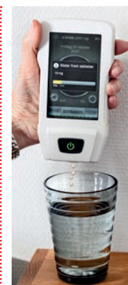
Inuti dosautomaten finns små snabbblösliga tabletter med levodopa som doseras rakt ned i ett vattenglas. Foto: Fotograf Sara Winsnes
